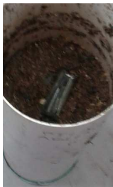
Figura 4. Columnas de percolación según Norma ASTM E2242-02 (2012).
