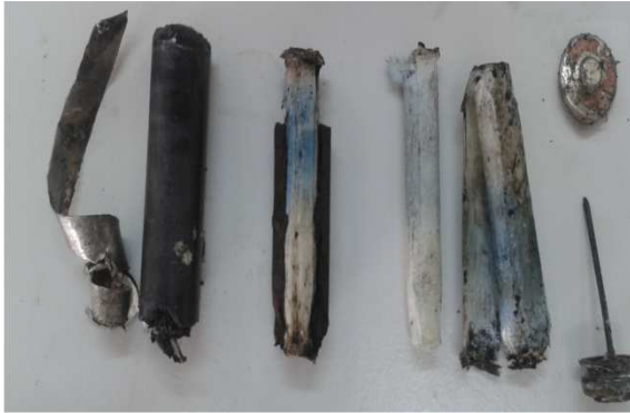
Figura 5. Componentes de pilas alcalinas
