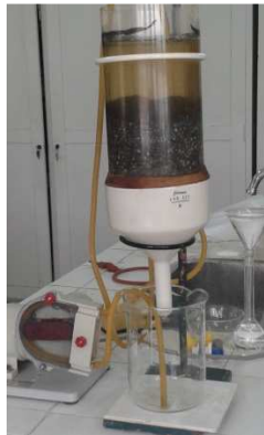
Figura 7. Columna de percolación: recuperación del KOH
