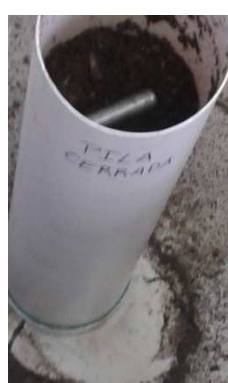
Figura 4. Columnas de percolación según Norma ASTM E2242-02 (2012).
