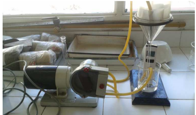
Figura 8. Columna de percolación: recuperación de Zn y Mn.
