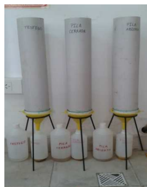
Figura 4. Columnas de percolación según Norma ASTM E2242-02 (2012).
