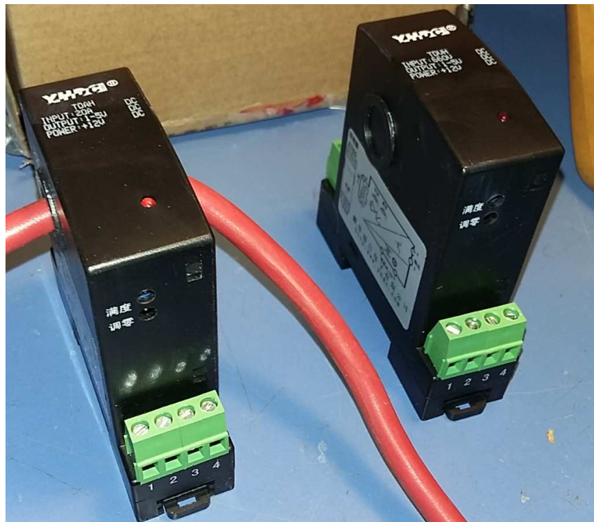
Figura 4 – Sensores YHDC de corriente (20 A)(izq.) y de tensión (600 V) integrados de Efecto Hall
