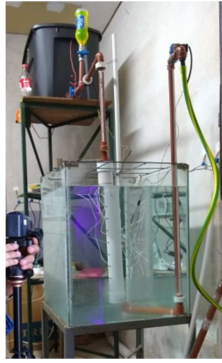
Figura 2: Banco de ensayo: el tanque, el estratificador y el tubo de succión. Arriba, el sistema de alimentación.
