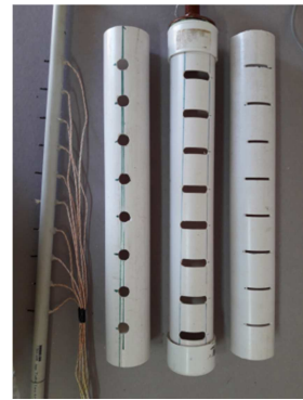
Figura 3: Estratificadores bajo estudio. De derecha a izquierda: rejillas delgadas (A), rejillas anchas (B) y orificios circulares, (C). A la izquierda, peine de termocuplas.
