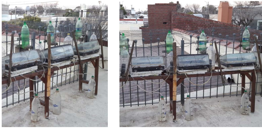
Figura 1: Vistas de los prototipos de destiladores en funcionamiento
