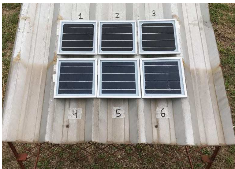
Figura 4: Protótipos de células de referência, PROT 1 (1), PROT 2 (2), PROT 3 (3), PROT 4 (4), PROT 5 (5) e PROT 6 (6).
