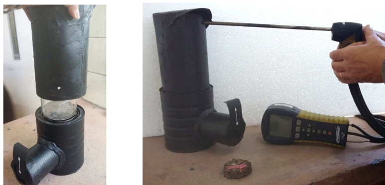
Figura 5: ubicación del vaso de precipitado sobre el soporte y horno con ducto guiador de gases
