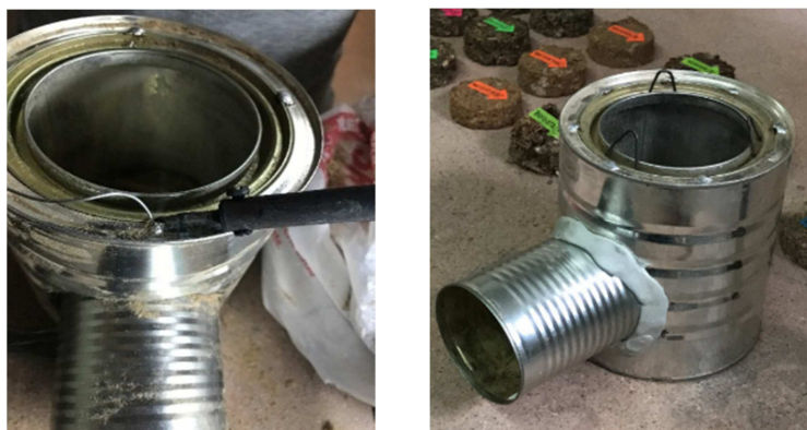
Figura 3: Armado y construcción del horno para la combustión de las briquetas
