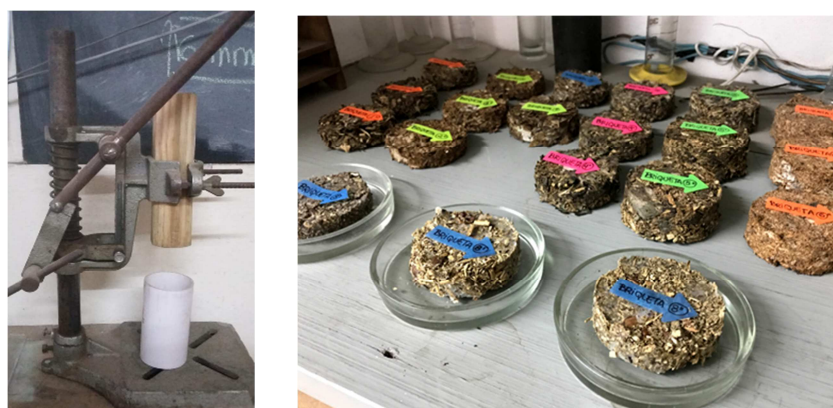
Figura 2: Prensa manual para compactación de mezclas y briquetas terminadas
