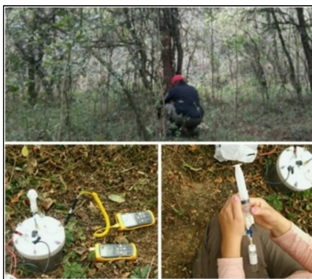
Figura 2: Muestreo (arriba), Cámara estática (CE) (abajo izquierda) y toma de muestras y trasvase a viales (abajo derecha).
