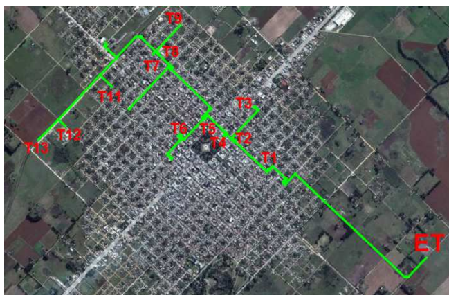
Figura 5: Captura del GIS – Línea 7 y sus transformadores.
