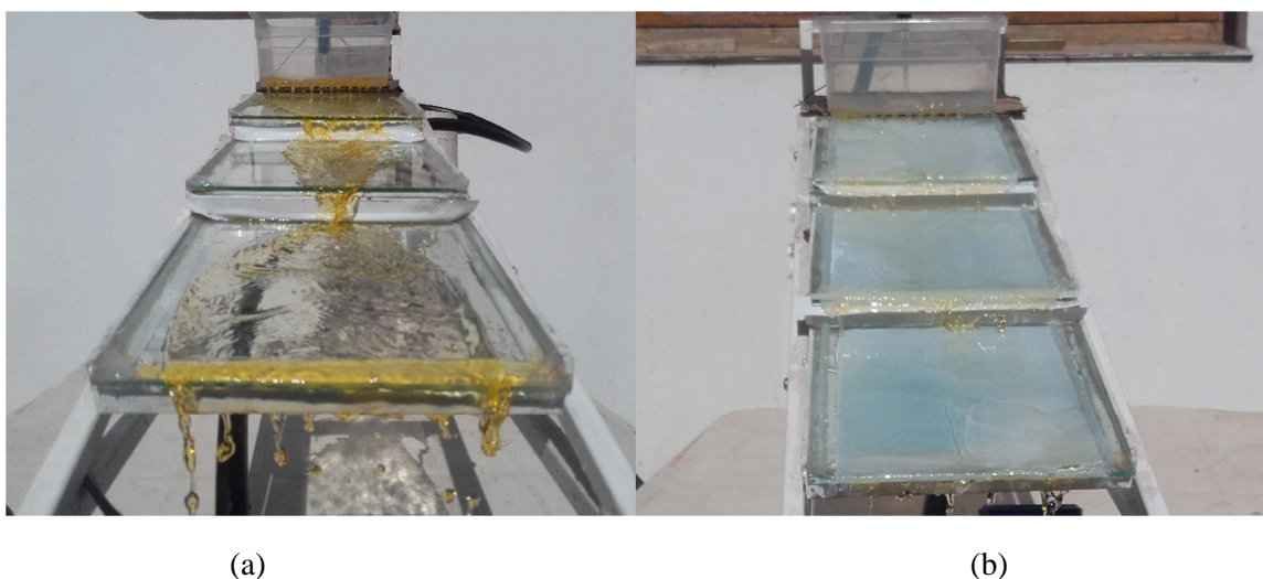
Figura 8: En esta se muestran las experiencias de fotocátalisis solar con \text{TiO}_2 en suspensión (a) y \text{TiO}_2 soportado (b)
