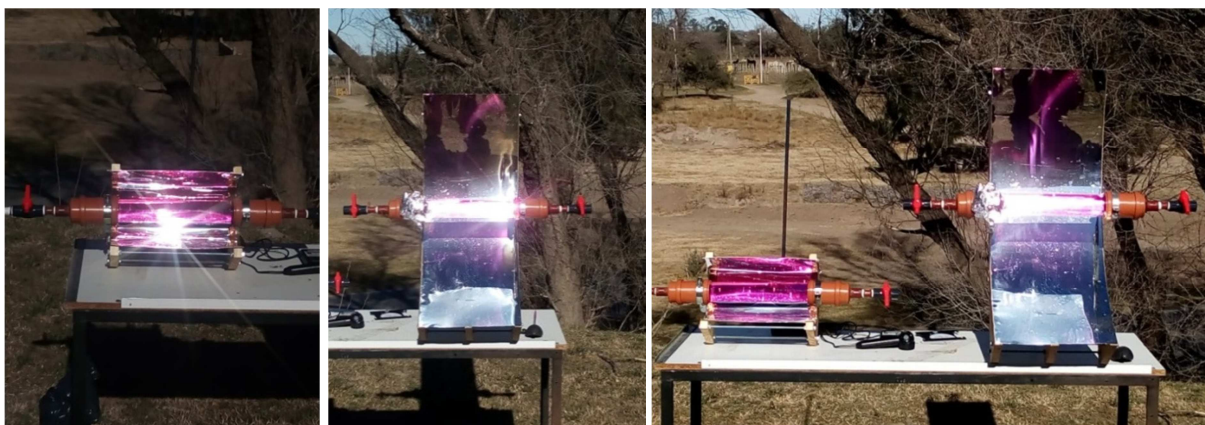
Figura 4: Desarrollo de una experiencia de decoloración con ambos reactores CP y CPC
