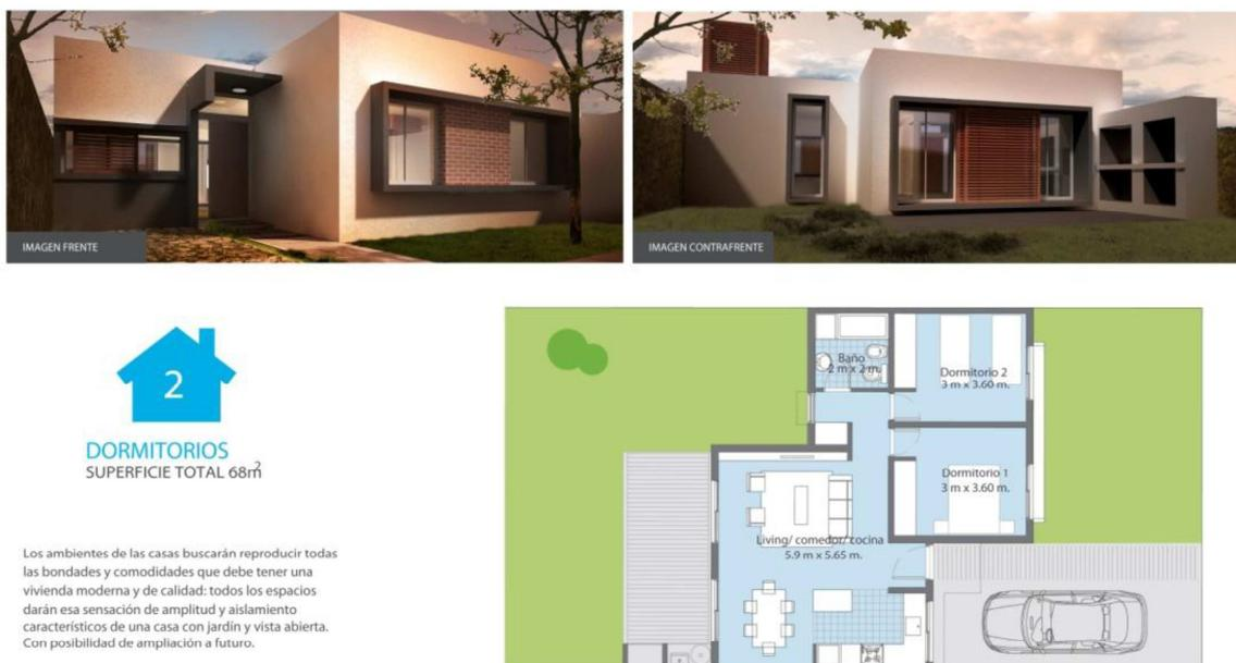
Figura 2: Vistas de Frente, Contrafrente y Planta, del modelo Saucos 2 dormitorios, utilizado para las simulaciones de perfil energético de las Situaciones Base y Propuesta.
