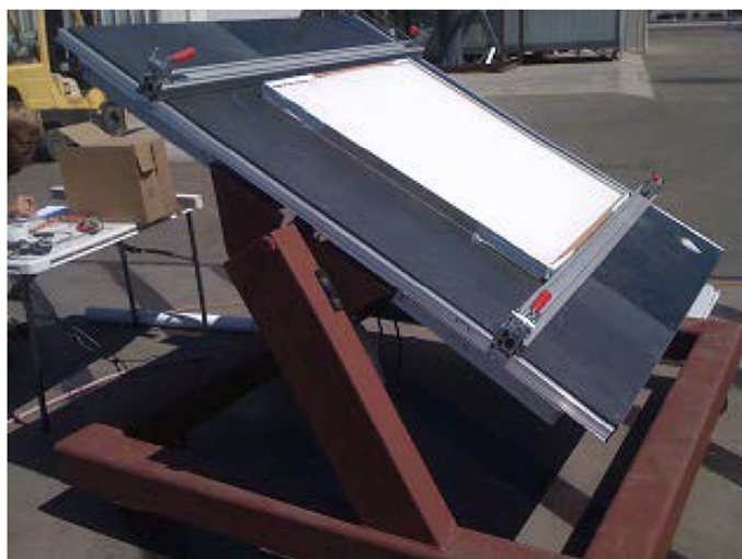
Figura 4: aparato de medición con una muestra colocada en el porta-muestra. (Fuente: NFRC, 2010).
